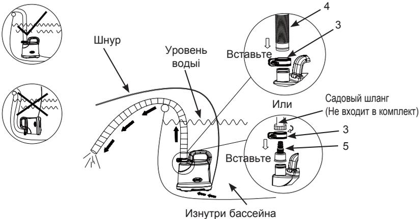
**ПРИМЕЧАНИЕ:** Глубина воды в бассейне не должна превышать 1,22 м. Чтобы защитить двигатель насоса от сухого хода, отсоедините кабель питания от электрической розетки после слива воды или когда уровень воды опустится ниже основания дренажного насоса.
